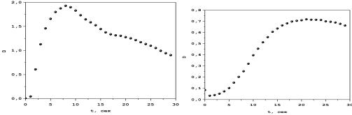
Рис. 12. Кривые изменения оптической плотности раствора DMTrT-*КПТ 4* в XM (а) и DMTrT-*КПТ 10* в XM (б) при  $\lambda$  = 506 нм, в результате воздействия излучения интенсивностью I = 140 мВт/см<sup>2</sup> с длинной волны 407 нм
