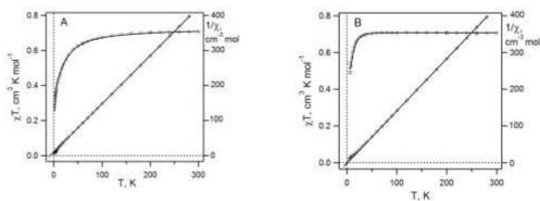
Рис. 6. Экспериментальные температурные зависимости  $\chi T$  и  $1/\chi$  анионрадикальных солей с бис(толуол)хромониевым катионом (точки) и их теоретическая аппроксимация (сплошные линии), основанная на уравнении Ван Флека и многоконфигурационных квантовохимических расчетах методом CASSCF
