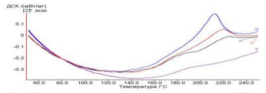
Рис. 1. Зависимости экзотермических тепловых эффектов отверждения МЭК от температуры (ДСК диаграммы): 1 - 9-31, 2 - 9-32, 3 - 9-33, 4 - 9-20
