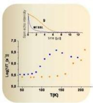
Температурные зависимости времён фазовой релаксации Т<sub>m</sub> (внизу) и кривые падения интенсивности спинового эха при 80 К (вверху) для радикалов 9 и MTSSL.
