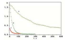
Рис. 9. Кинетики изменения оптической плотности растворов, содержащих производное фталоцианина (1) и тиоэритрозин (3), при облучении на длине волны 690 нм, и тиоэритрозин (2) при облучении на длине волны 547 нм
