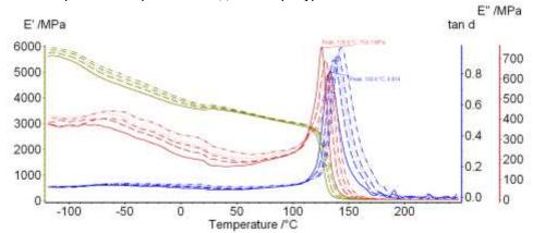
Рис. 4. Зависимости модуля упругости Е', модуля потерь Е" и тангенса угла механических потерь tan δ МЭК от температуры
