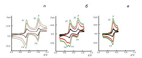
Рис.9. Циклические вольтамперограммы соединения **3** в ДМСО (а), в бинарной смеси ДМСО: $H_2O$  (б), а также в диапазоне развертки потенциала 0.3<E<-0.6 V. (Скорость развертки потенциала 1- 0.1 V/s, 2- 0.7 V/s (красный цвет), 3- 1.1 V/s (зеленый цвет), фоновый электролит  $Et_4NCIO_4$  (0/1M)), Pt рабочий электрод
