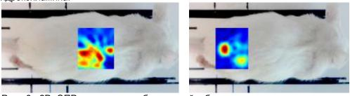
Рис. 6. 2D ЭПР томограммы брюшинной области мыши, полученные после внутривенной инъекции 200 мкл 150 мМ раствора радикала R1. Параметры записи томограммы: область наблюдения,  $20x20 \text{ мм}^2$ , градиент поля, 5 Гс/см, кол-во проекций, 31, время сканирования 4 минуты.
