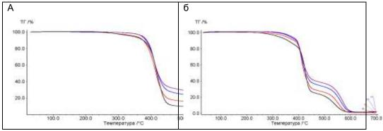
Рис. 3. Зависимости потерь веса МЭК от температуры в инертной (а) и окислительной (б) атмосфере (ТГ диаграммы): 1 – Э-20, 2 – Э-31, 3 – Э-32, 4 – Э-33
