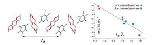
Схема 4. Длина элементарного звена супрамолекулярного 1D ансамбля *мета*ариленди-аминов и 18-краун-6; обратная линейная зависимость теплоты плавления от длины звена
