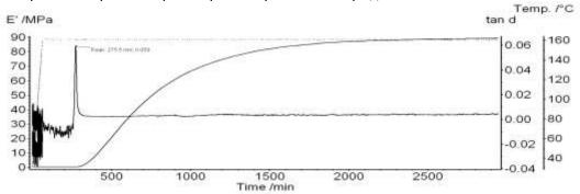
Рис. 2. Зависимость модуля упругости и тангенса механических потерь от продолжительности отверждения 3-20
