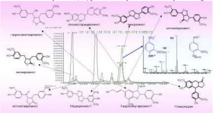
Рис. 4. Детальный спектрально-хроматографический профиль лигнанов древесины лиственницы *Larix Sibirica*
