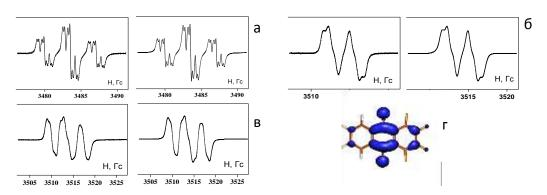
Рис. 12. Спектры ЭПР (слева) и их численные реконструкции (справа) анионрадикалов фторированных антрахинонов  ${\bf 5}$  (а),  ${\bf 6}$  (б),  ${\bf 7}$  (в), а также видраспределения спиновой плотности в AP  ${\bf 5}$  (г) по данным расчетов (U)B3LYP/6-31+G\* (г)
