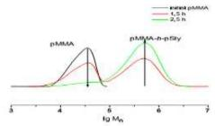
Рис.1. Результаты ГПХ анализа реакционной смеси при инициировании полимеризации стирола высокомолекулярным алкоксиамином на основе полиММА.
