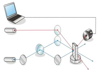
Рис. 2. Экспериментальная установка для записи фазовых пропускающих дифракционных решеток. 1 компьютер; 2 – Не-Nе лазер  $(633 \text{ нм}); 3 - \text{зеркала}; 4 - \text{Ar}^+$ лазер (488 нм) или DPSS лазер (375 нм); 5 измеритель мошности Coherent LaserCheck; 6 светоделительное зеркало; 7 - образец, 8 - вращающийся автоматизированный держатель образцов
