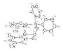
Рис. 3. Строение синтезированного хирального иминофосфорана по данным РСА
