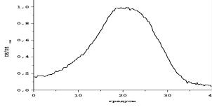
Рис. 3. Нормированная кривая угловой селективности дифракционной решетки, записанной в фотополимерный слой, сенсибилизированный производным фенантренхинона Ф7
