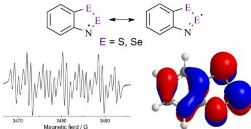
Рисунок 4. Архетипный радикал Херца, представленный суперпозицией двух структур, его спектр ЭПР ( E = S ), и полузанятая \pi^* -МО.
