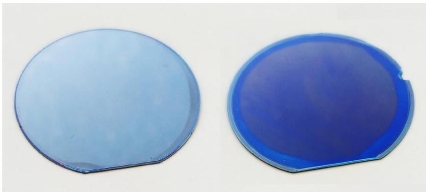
**Рисунок 2.1.** Карты распределения толщины пленки ПММА-1 на Si(100) пластине, полученные методом сканирующей спектральной эллипсометрии, а также примеры изображения кремниевых пластин с разными толщинами пленок: 40 нм (слева) и 92 нм (справа).
