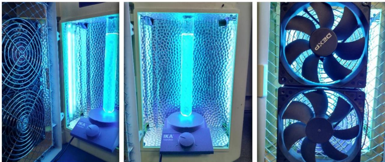
Рисунок 4.2 – Фотореактор периодического действия, используемый в синтезе тиено[3,2-с]хроменов.
