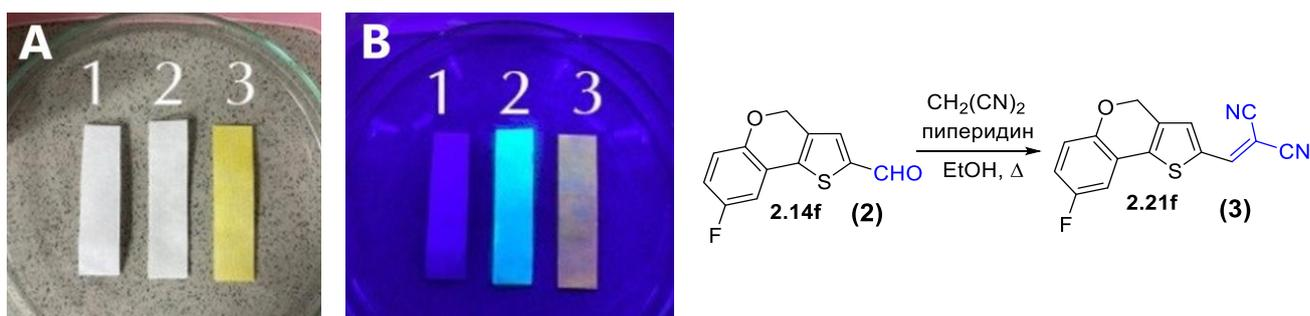
Рисунок 3 – Фотографии в дневном свете (**A**) и УФ свете (**B**): 1) Необработанной бумаги; 2) Бумаги, смоченной раствором соединения **2.14f** в EtOH и впоследствии высушенной; 3) Бумаги, обработанной раствором соединения **2.14f** и проявителем (1% раствор малондинитрила с каталитическим количеством пиперидина в EtOH) и далее высушенной.
