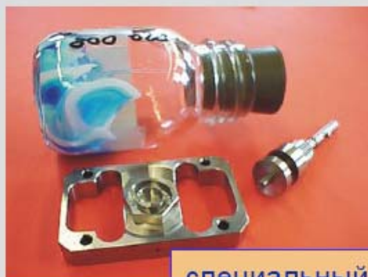
специальный держатель для высоковязких проб
